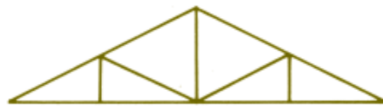
tesoura de telhado
